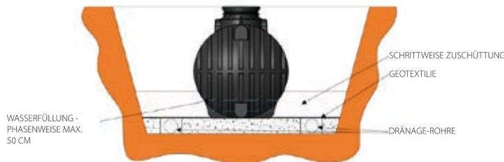
Abbildung 7: Behältereinbau in schlecht durchlässige Bodenflächen
